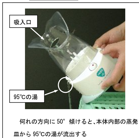
写真5. 本体内部の蒸発皿から湯が流出 (No. 3)
