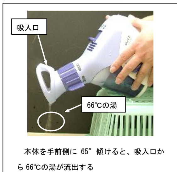
写真4. 吸入口から湯が流出 (No. 2「のど」「はな」モード)
