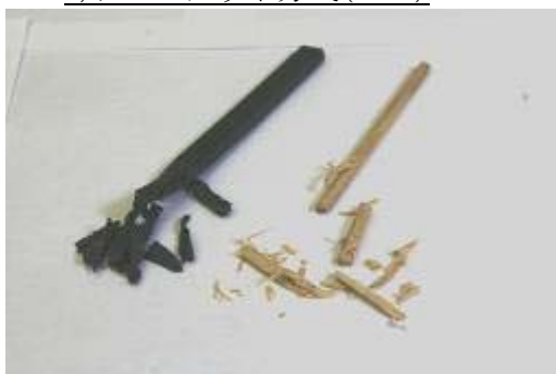
写真 4 切断されたゴム片と木製の丸棒(例)
