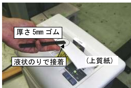
写真 1 指の引き込まれを想定した試験
