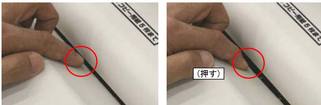
写真2 投入口の幅が変形して広がる銘柄(No.6)(例)
